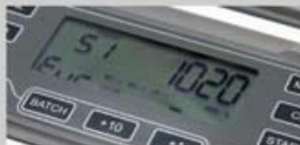
El panel táctil, está sellado impidiendo la penetración de líquidos y polvo en la unidad de control.
